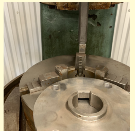
Med en av de lite mer udda maskinerna i verkstaden kan Stefan ta upp riktigt grova kilspår.
