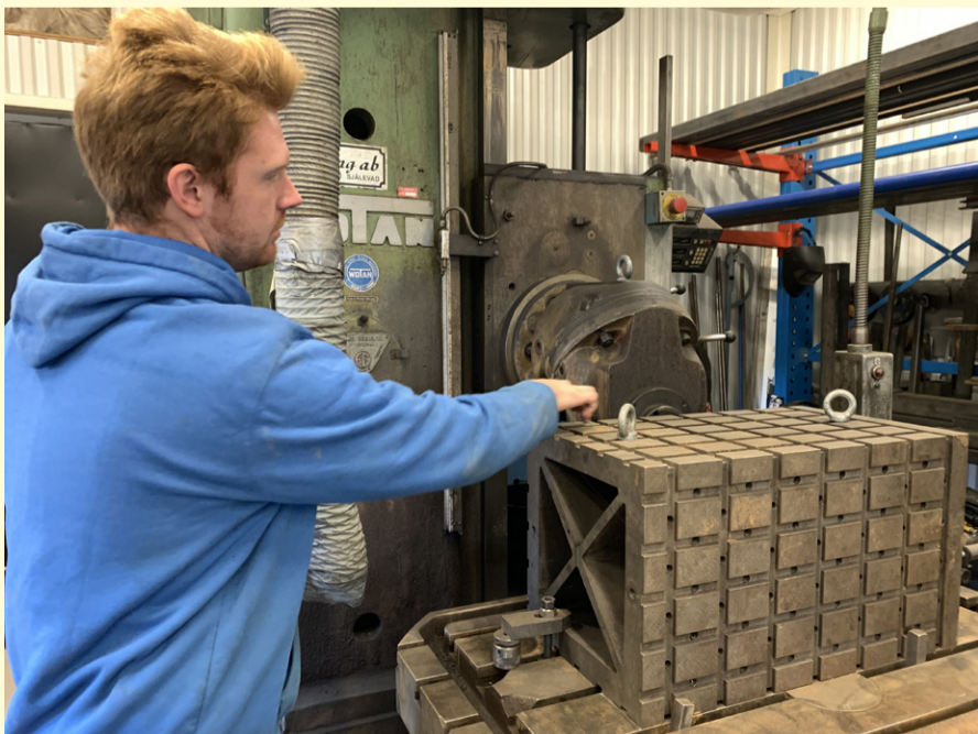
Arborrmaskinen kan även användas för fräsarbeten, blocket illustrerar detta.
