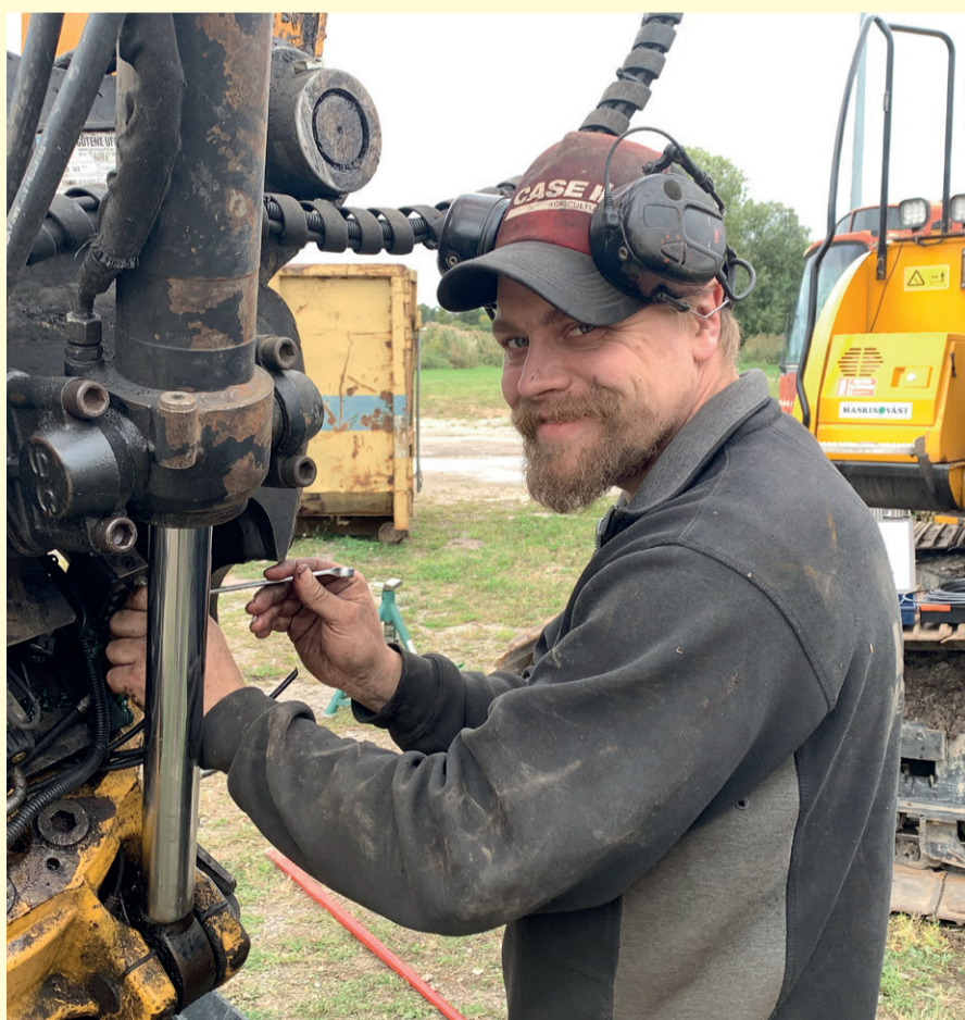
Richard Lundberg i full färd med att byta en wire på en grävmaskin.
